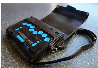
Рис. 11 Портативный компьютер с вводом/выводом шрифтом Брайля и синтезатором речи «ElBraille- W14J G1»
