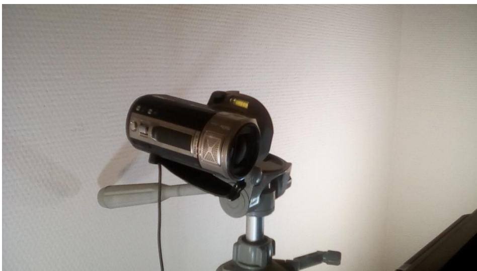
Рис 5. Основное оборудование для автономного полипозиционного наблюдения – камеры Panasonic HC-V720M, FullHD, 50 fps.
