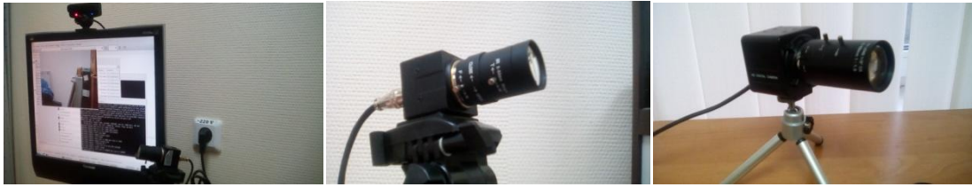
Рис 8. Высокоскоростные Web-камеры, работающие под ОС Linux. (640x480 60 fps; 640x480 120 fps).
