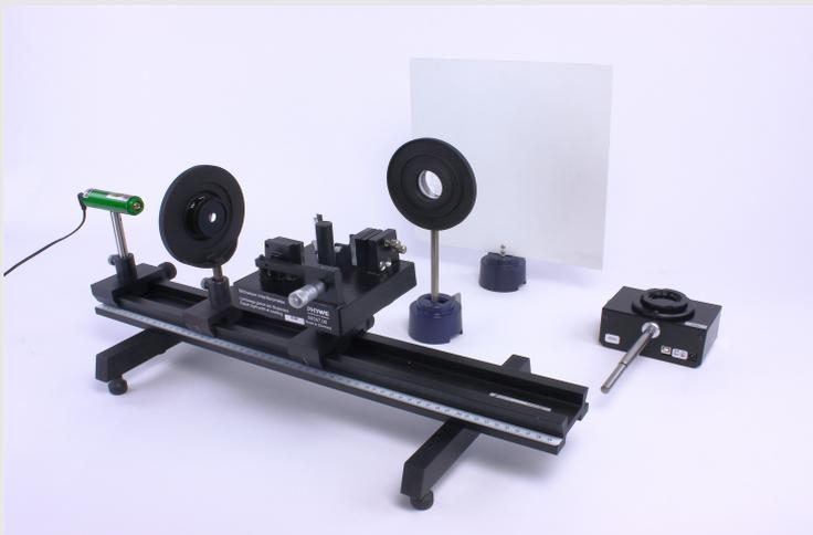
Экспериментальная установка для измерения длин волн с помощью интерферометра Майкельсона
