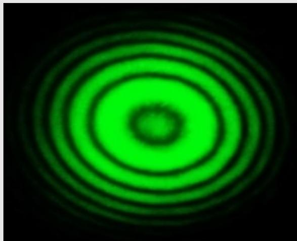
Интерференционные кольца с помощью интерферометра Микельсона.
