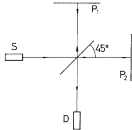
Установка интерферометра Майкельсона
