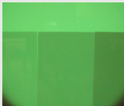
Рис. 2: Алюминий, слева направо: d = 0,3 мм, 0,5 мм и 1 мм.
